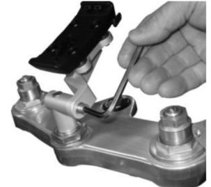
NL : Stel de hellingshoek in en draai de bout aan. (max. 10Nm) GB : Adjust the viewing-angle and tighten the bolt. (max. 10Nm) D : Gewünschten Blickwinkel einstellen und die Schraube mit max. 10Nm anziehen.
